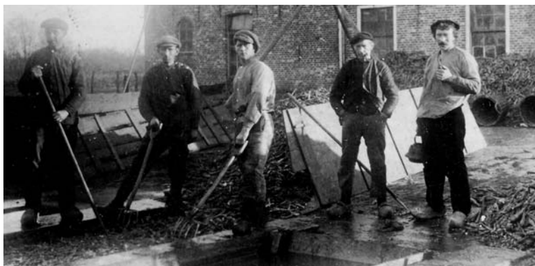
Het wassen van de wortels gebeurde in een speciale houten wasbak (wask) of in een afgeschermd deel van de vaart bij de fabriek of bij de boer. Voor het snijden en drogen van de wortels was het belangrijk dat er zo weinig mogelijk aarde aan de wortels zat. (Cultuurhistorisch Centrum De Sûkerei)
